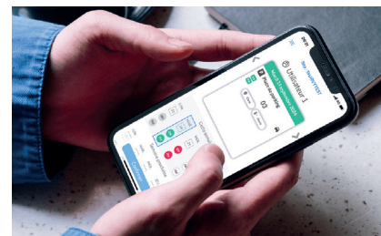
Les bornes de recharge électriques à la norme OCPP disposent d'une app qui facilite l'automatisation des déclarations de consommations électriques par utilisateur, grâce à des badges physiques ou virtuels.
